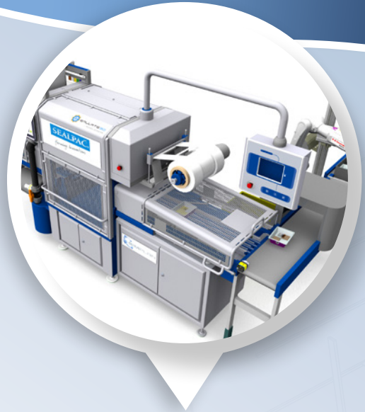
Foto: Virtuelle Inbetriebnahme einer Verpackungsanlage
